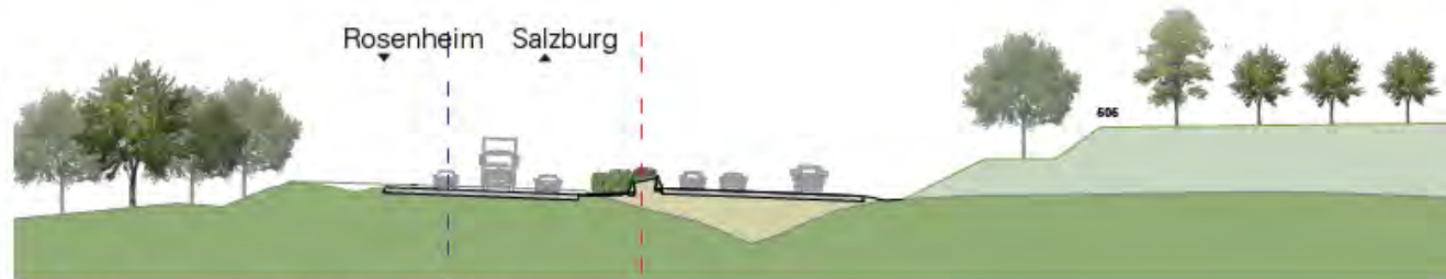
A - A' V 2 ausgezogene Böschung (mit Stufe)
